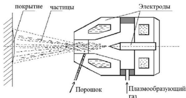
Рисунок 3 Схема плазменного нанесения покрытий
